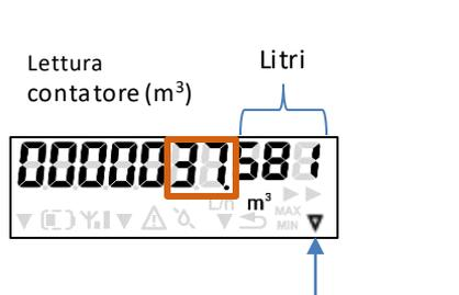
Ai fini della comunicazione della lettura si ricorda che la cifra visualizzata è composta da alcuni termini prima la virgola (ossia i metri cubi) e da altri termini dopo la virgola (nello specifico i litri)
